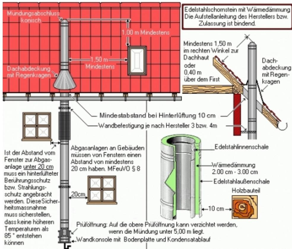
Das anfallende Kondensat ist ordnungsgemäß abzuleiten (gilt nur für flüssige und gasförmige Brennstoffe). Hierfür sind die zur Zeit gültigen wasserrechtlichen Vorschriften der Länder und Satzungen der örtlichen Entsorgungsunternehmen maßgebend.
